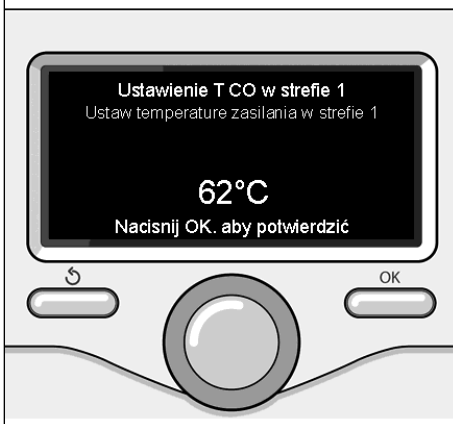
Zmiana temperatury ciepłej wody do ogrzewania
